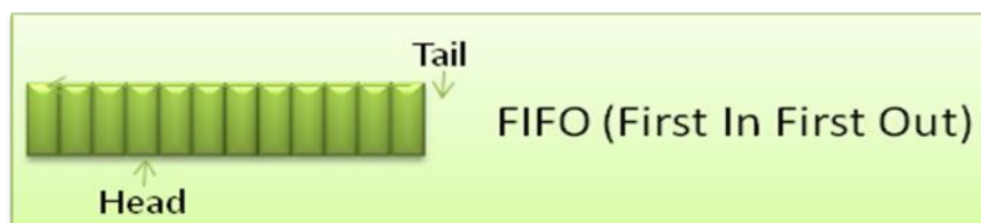
Рис.23.6. Head – голова показывает на первый заполненный слой, который будет обслуживаться. Tail – на первый пустой. (Для симметризации)
